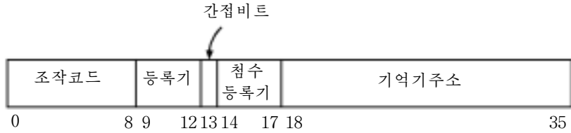
그림 10-5. PDP-10 명령형식
