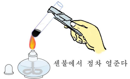
그림 14. 수산화동의 만들기와 성질, \text{Cu}^{2+} 검출
