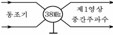
그림 6-13. 결면파사기려파소자에 의한 대역려파회로
